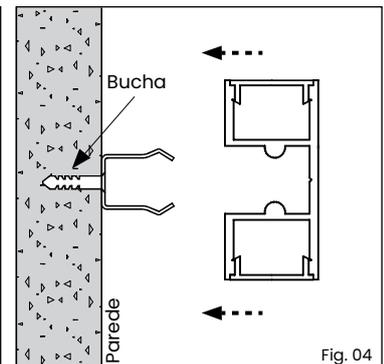
1° - Fixe a mola na parede e/ou no teto, com buchas e parafusos adequados, dividindo em distâncias iguais conforme comprimento de cada perfil;
