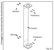
1º - Fixe a luminária na parede utilizando-se dos parafusos e buchas que acompanham a peça;
