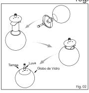
2º - Instale a lâmpada específica no soquete;
