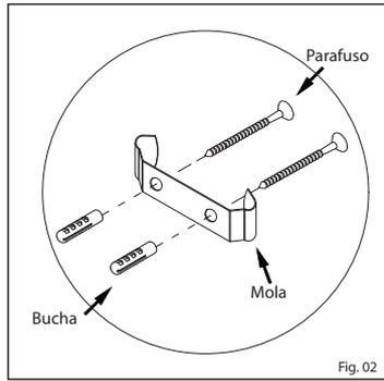
2º - Fixe as molas à parede utilizando-se das buchas e parafusos;
