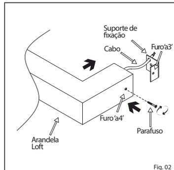
4º- Erga a Arandela Loft, posicionando o Suporte de Fixação em seu interior;
