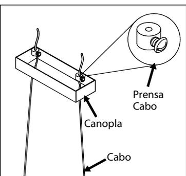
2º - Passe os cabos pelos furos da canopla e em seguida pelo prensa cabo;
