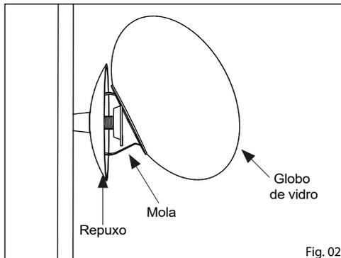
3º - Incline o globo na direção oposta para encaixar as duas extremidades da mola dentro da borda do globo;
