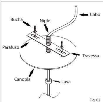
5º - Passe o cabo através da luva, em seguida pela canopla, pelo interior do niple, como especificado na Fig. 02;
