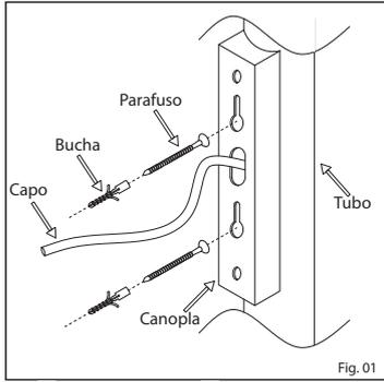
1º - Execute a instalação elétrica através do cabo localizado na canopla como demonstrado na Fig. 01;
