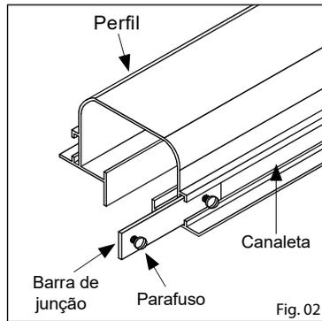
3º - Encaixe a barra de junção nas canaletas laterais do perfil;
