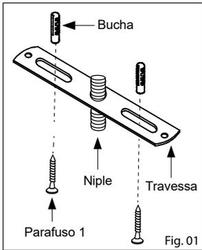
1º - Fixe a travessa no teto, utilizando as buchas e parafusos adequados;
