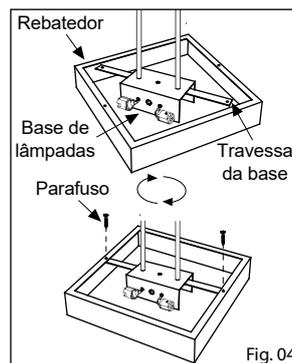
7º - Para encaixar o rebatedor, suba-o em uma posição de forma que a travessa da base de lâmpadas fique na diagonal para passar pela moldura do rebatedor e depois gire-o, deixando apoiado na travessa;
