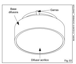
7º - Apoie a base difusora nas garras da base de lâmpadas, certificando que a base está devidamente encaixada às três garras;
