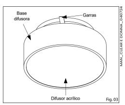
7º - Apoie a base difusora nas garras da base de lâmpadas, certificando que a base está devidamente encaixada às três garras;
