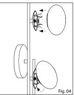
7º - Segure o globo de vidro com delicadeza diante da mola; 8º - Cuidadosamente, incline o globo para encaixá--lo em baixo de uma das extremidades da mola; 9º - Incline o globo na direção oposta para encaixar as duas extremidades da mola na direção oposta;
