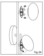
7° - Segure o globo de vidro com delicadeza diante da mola; 8° - Cuidadosamente, incline o globo para encaixá-lo em baixo de uma das extremidades da mola; 9° - Incline o globo na direção oposta para encaixar as duas extremidades da mola na direção oposta;
