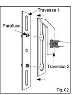
4° - Encaixe a travessa 2 alinhando os furos com os parafusos da travessa 1;
