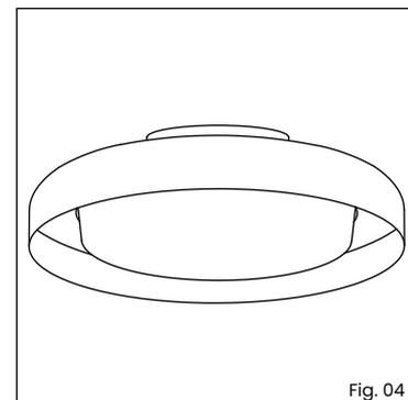
1º - Separe a travessa da canopla, girando-a para que os parafusos laterais saiam pelas fendas da canopla;
