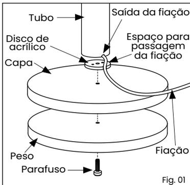
1º - Coloque o peso dentro da capa da base, apoie o disco acrílico sob a capa, alinhando os furos centrais e rosqueie o parafuso por baixo do peso;
