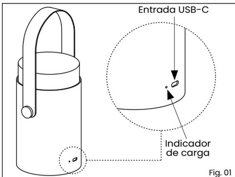
1º - Carregue a luminária através da entrada USB-C por 4 horas para a carga completa. Observe o indicador de carga para identificar a situação da bateria, onde a luz de cor vermelha sinaliza que está carregando e a luz de cor azul indica que o produto está com a
