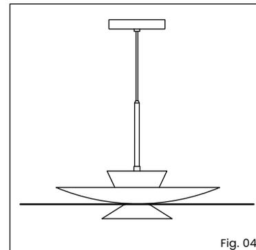
**OBS.: Para a troca de lâmpada, desrosqueie a luva para soltar a haste do soquete, desça-a, retire a lâmpada e execute novamente os passos 1 a 3.**
