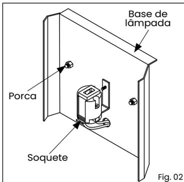
3º - Encaixe a base de lâmpada na travessa, passando os parafusos 2;
