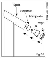
para dentro do spot: 10° - Encaixe o anel na ponta do spot.
