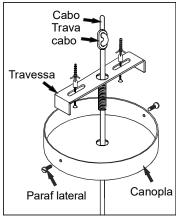
CANOPI A GESSO / PADRÃO / DRIVER - Desrosqueie os Parafusos Laterais da Canopla, soltando a Travessa. 2° - Utilize Bucha e Parafuso para fixar a
