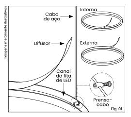
1º - Retire cuidadosamente o difusor para a passagem dos cabos e instalação de fita LED;
