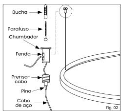
5º - Nas opções de canopla Blank (Fig. 4 e 5) ou canopla Canudo (Fig. 6), utilize buchas e parafusos adequados para fixar o chumbador ao teto;
