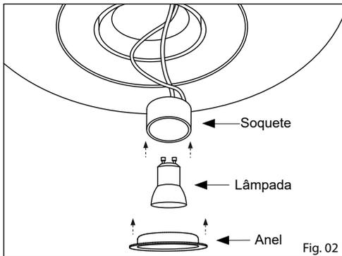
1º - Para os produtos que utilizam lâmpadas, conecte a lâmpada no soquete, aloque o soquete dentro da luminária e finalize encaixando o anel;
